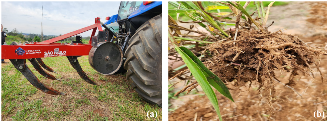
Figura 4. Subsolador preparado para operação (a) e raízes favorecendo a porosidade e atividade biológica do solo (b). Foto: Antoniane Arantes de Oliveira Roque.
