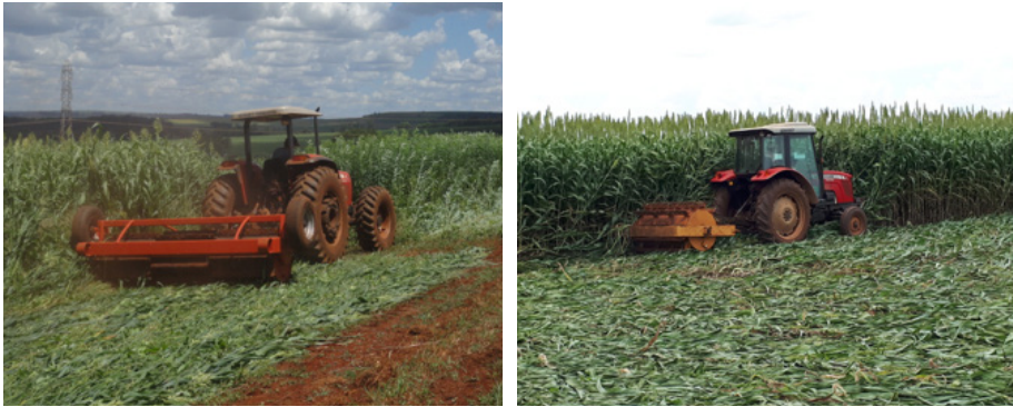
Figura 14. Rolo faca na terminação mecânica de plantas de cobertura, no caso o sorgo, para plantio direto de tomate sem utilização de herbicida. Foto: Branco, R. B. F. (2018).
