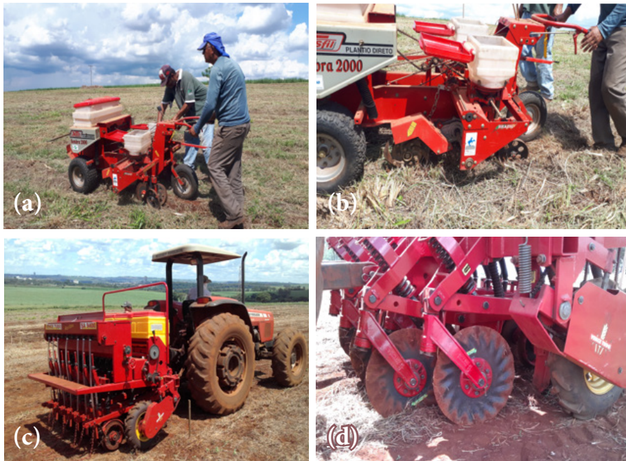
Figura 3. Implemento para pequenos produtores para semeadura em plantio direto sobre a palha de cereais e plantas de cobertura (a, b) e semeadora de médio porte para plantio direto sobre a palha (c, d). Foto: Branco, R. B. F. (2021).
