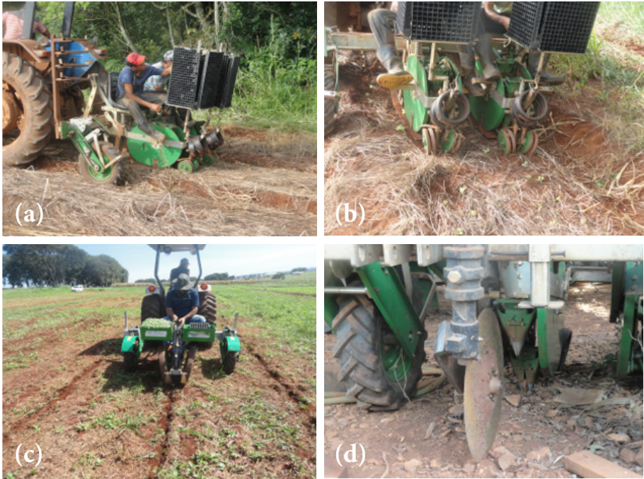
Figura 4. Transplantadoras de mudas de hortaliças adaptadas com disco de corte de palha para plantio direto na palha. Transplântio de alface (a, b), do tomateiro (c) e detalhe do disco corta palha (d). Foto: Branco, R. B. F. (2018).
