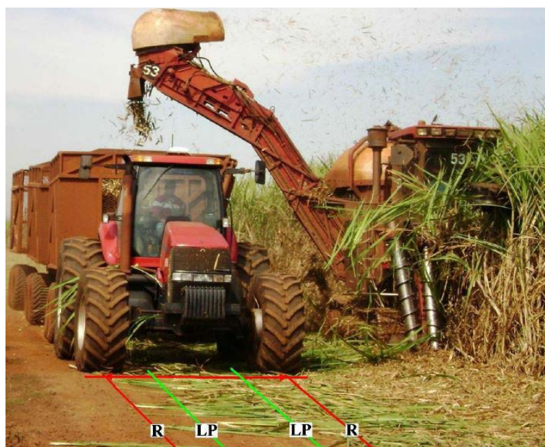
Figura 19. Controle de tráfego para reduzir a compactação. R = iodado, LP = linha de plantio. Foto: Antoniane Arantes de Oliveira Roque, CATI/SAA.
