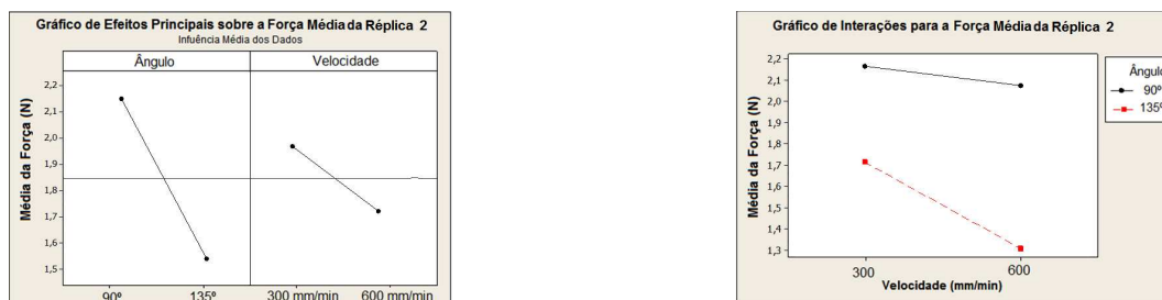
FIGURA 8. Gráfico de Efeitos Principais (a) e de Interações (b) para a Força Média - réplica 2.
